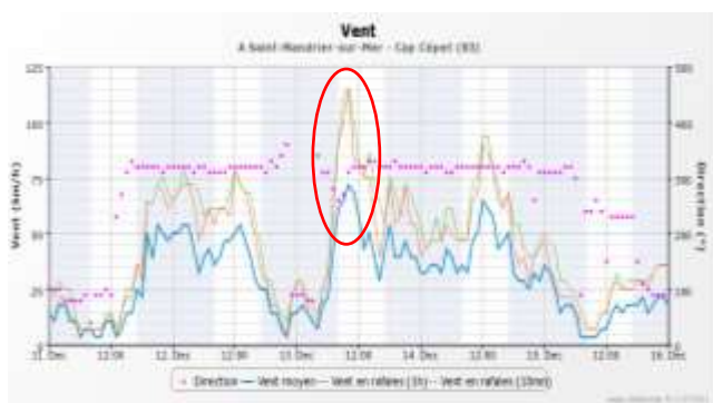
Figure 3 : Evolution de la vitesse et de la direction du vent entre le 11 et le 16 décembre 2019 mesurées à la station météorologique Météo-France du Cap Cépet. Dans le cercle rouge la période de rejet simulé de l'exercice le 13 décembre avec des vents dépassant les 110km/h. (Source : https://www.infoclimat.fr )
